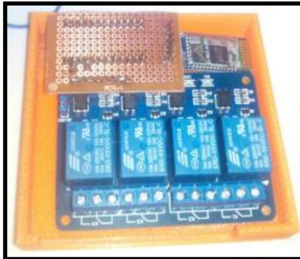
**Figura 20.** Conexión de elementos del módulo de control
