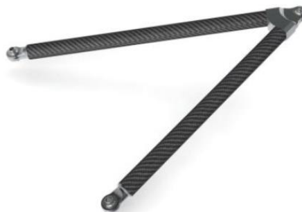
Figura 4.5. Brazos de la suspensión de un monoplaza [2].
