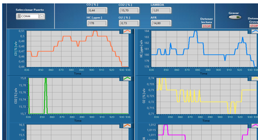
Figura 72. Emisiones con falla (A75,B1.0,C30).
