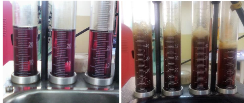
Figura 68. Pruebas de caudal de inyectores.
