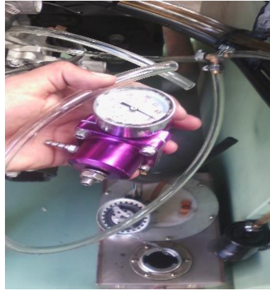
Figura 12. Montaje de regulador de presión en el Motor SM7 V6.
