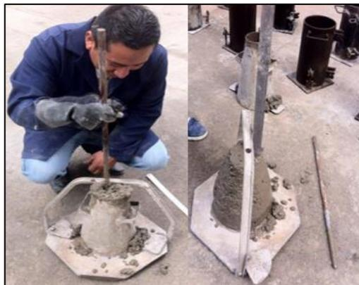
**Figura 6.** Ensayo de revenimiento
