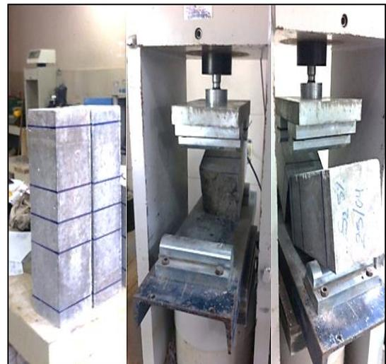
**Figura 10.** Ensayo a flexión de vigas: (a) Preparación de especímenes, (b) Especímen sin escoria, (c) Especímen con escoria de hierro
