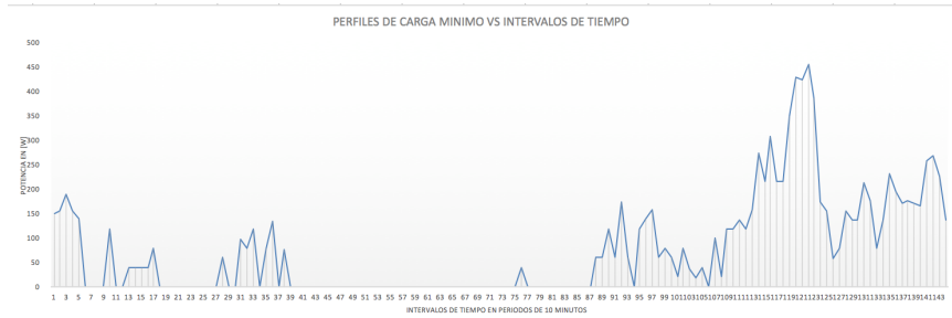
Figura 3.11: Perfil de carga mínimo del usuario final vs intervalos de tiempo de 10 minutos
