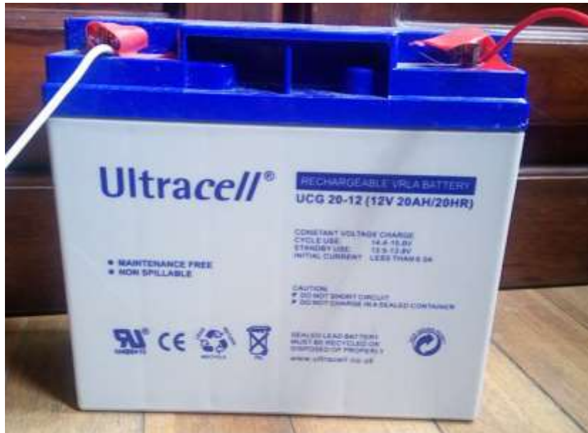
Figura 3. 11. Batería Ultracell Rechargeable VRLA.
