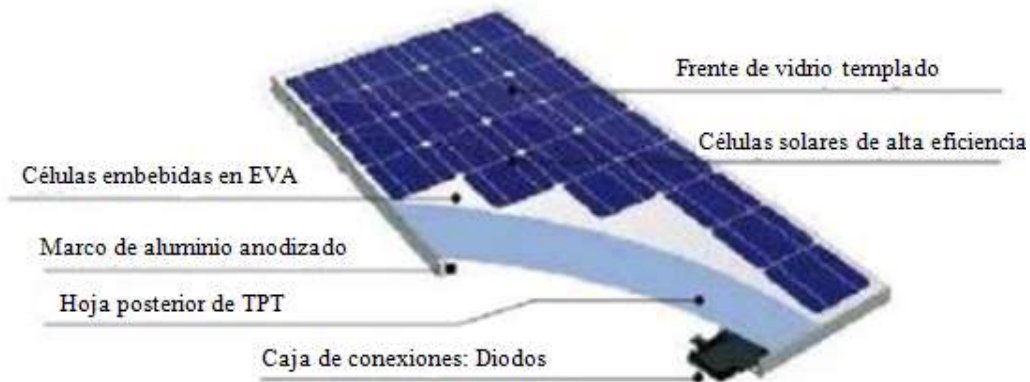
Figura 3. 8. Descripción de componentes del panel solar EXMORK. (Proviento, 2016)
