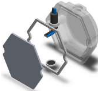
Figura 2. 8. Carcasa del módulo LED ofrece una resistencia de impacto de IK08. ( LED Revista )
