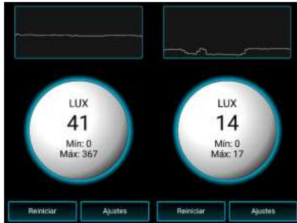
Figura 4. 8. Mediciones de lux con el conjunto de módulos LED (3m=41lux), (4m=14lux). ( Luxómetro, 2016 )
