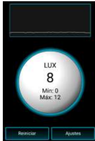
Figura 4. 9. Mediciones de lux con el conjunto de módulos LED (5m=8lux). ( Luxómetro, 2016 )
