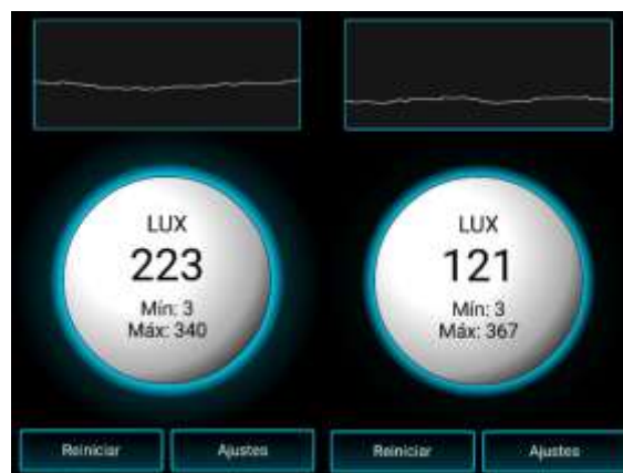
Figura 4. 7. Mediciones de lux con el conjunto de módulos LED (1m=223lux), (2m=121lux). (Luxómetro, 2016)
