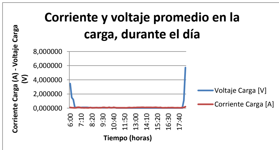
Figura 3. 19. Corriente y tensión promedio en la carga durante el día, medido en Labview.
