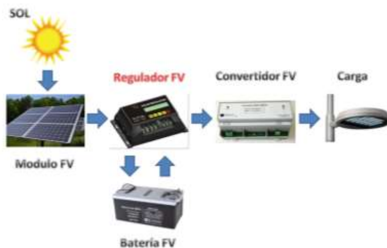
Figura 1. 7. Regulador solar montado en un sistema FV para luminaria LED.
