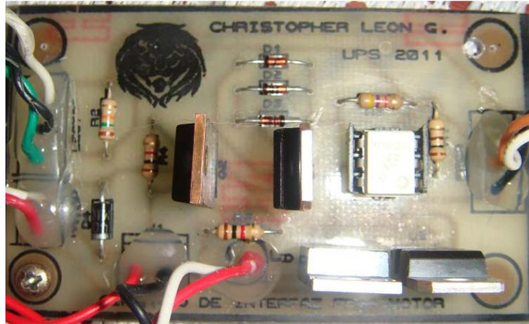
**FIGURA 44. PISTAS Y SOLDADURA DE LA PLACA DE INTERFAZ FPGA-MOTOR DC.**
