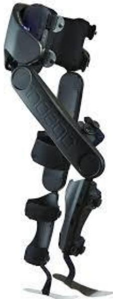
**Figura 1.7:** Exoesqueleto modular INDEGO.
