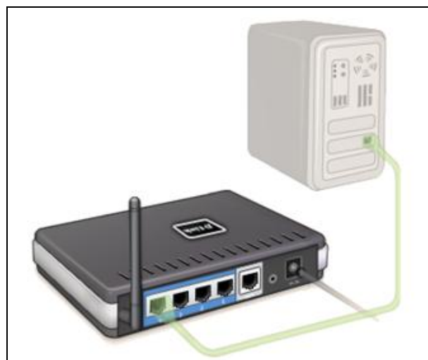
Figura 3.71 Conexión router con un computador
