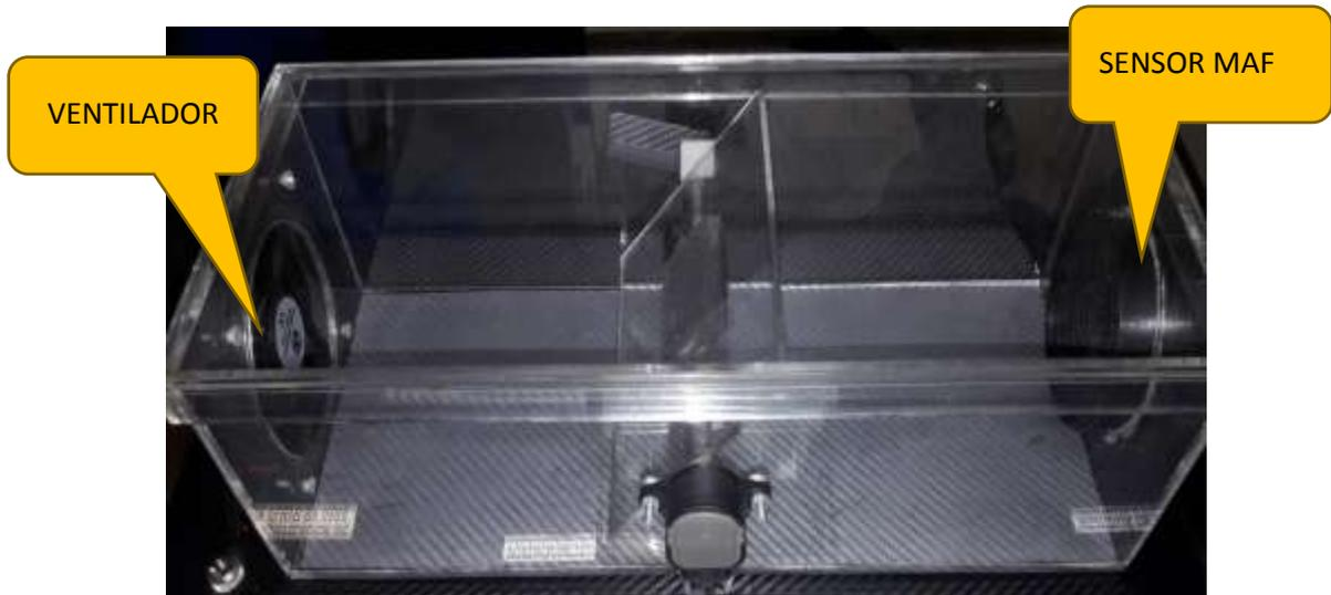
Figura 50. Sistema para medir el flujo de aire.
