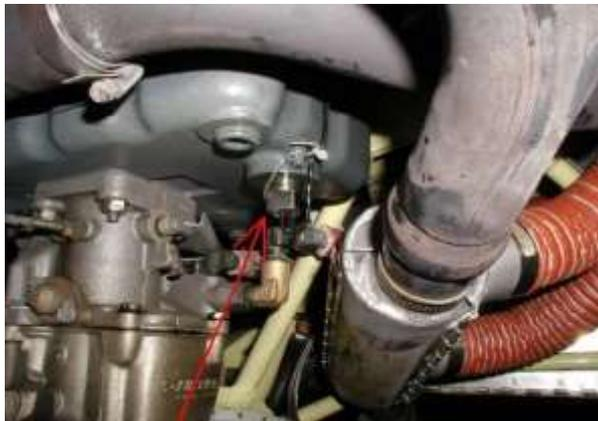
Figura 8. Ubicación del sensor de presión de aceite. [4]
