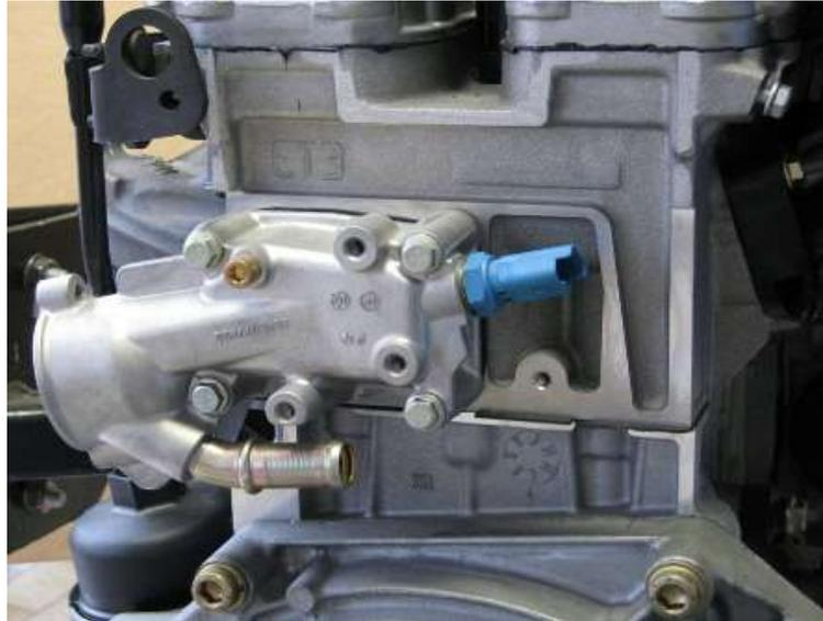
Figura 5. Sensor NTC montado en la caja del termostato. [2]
