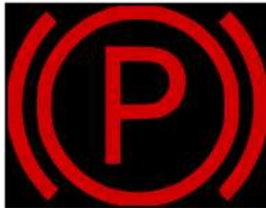
Figura 28. Luz testigo del freno de mano.
