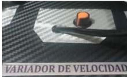
Figura 42. Ubicación del potenciómetro de control de giro del motor.
