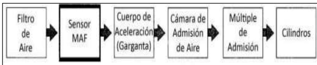
Figura 20. Ubicación del sensor de flujo de masa de aire. [8]
