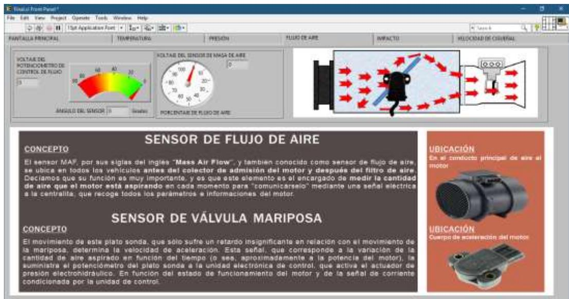
Figura 60. Pantalla de los sensores de flujo de aire.
