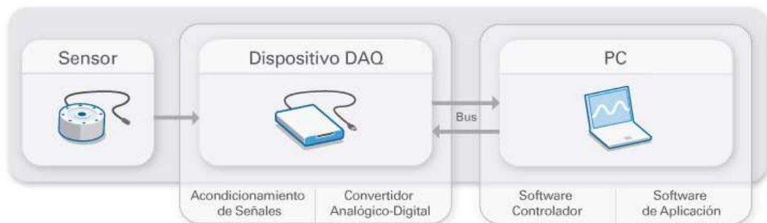
Figura 29. Partes de un sistema de adquisición de datos. [10]
