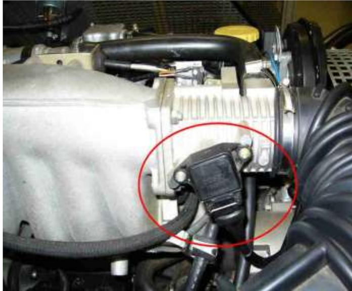
Figura 19 Ubicación del potenciómetro de válvula de mariposa. [2]
