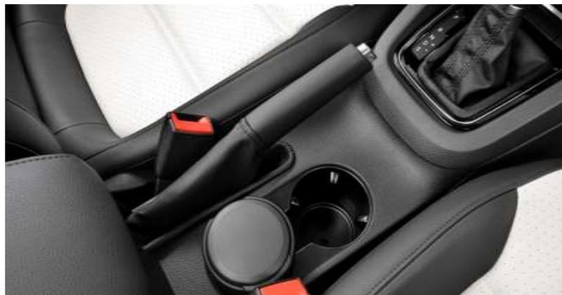
Figura 26. Palanca y pulsador de freno de mano.
