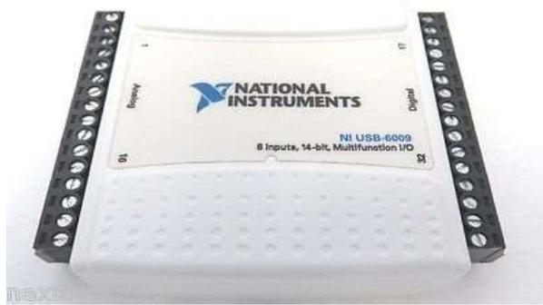
Figura 30. Tarjeta NI USB 6009 DAQ. [10]
