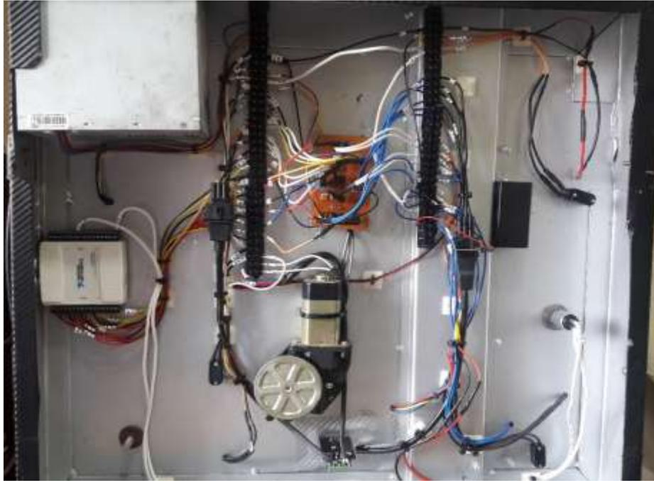
Figura 76. Conexión de los sensores al NI USB 6009 DAQ.
