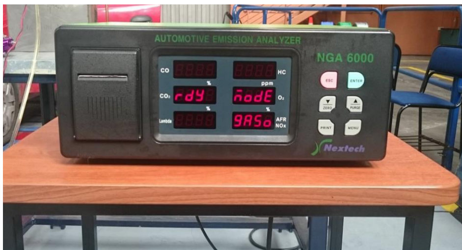
Figura 6.4. Analizador de gases Nextech NGA 6000.
