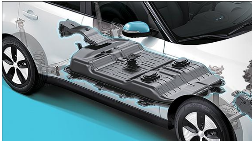
Figura 4: Baterías de Litio.
