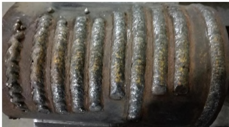
Figura 63. Eje principal con soldadura de las pruebas realizadas.
