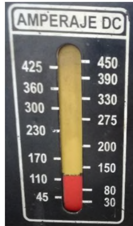
Figura 60. Amperaje para pruebas de máquina de soldar
