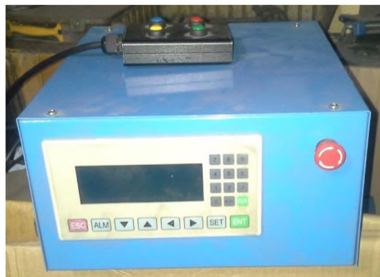
Figura 38. Caja de mando y control de motor paso a paso.
