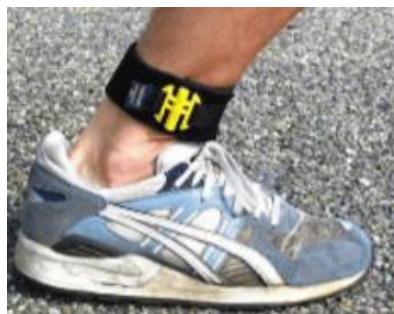
Figura 39: Colocación INCORRECTA de etiquetas RFID.
