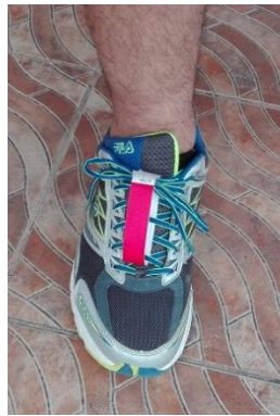
Figura 38: Colocación CORRECTA de etiqueta RFID.
