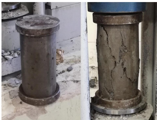
Figura 4. Probeta antes y después del ensayo de compresión
