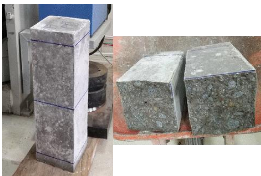
Figura 5. Probeta sometida al ensayo a flexión
