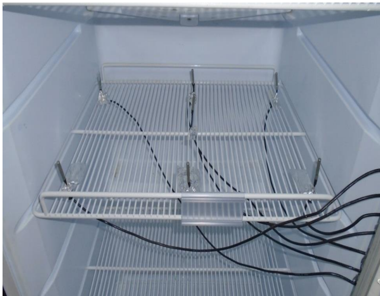
Figura 45. Termocuplas colocadas en el centro geométrico Fuente: Autor
