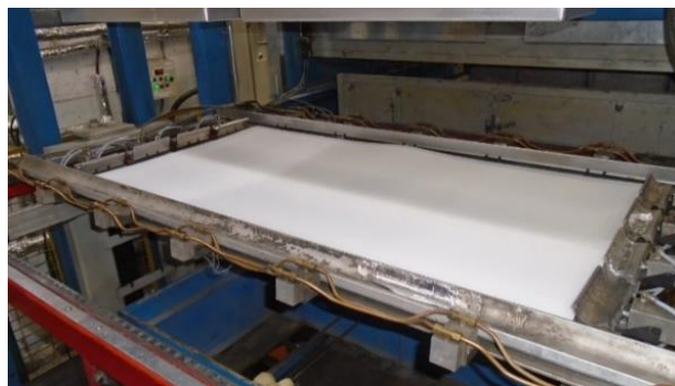
Figura 11. Cargado de Lámina en Termoformadora. Fuente: Autor
