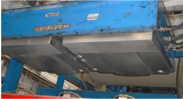
Figura 12. Molde de aluminio montado en Termoformadora. Fuente: Autor
