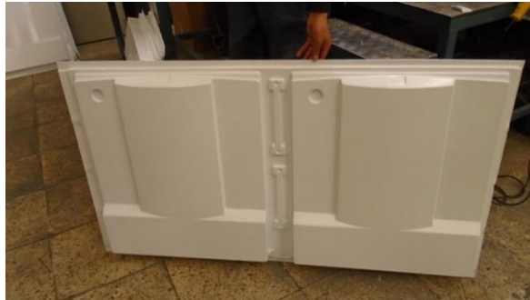
Figura 13. Cobertor Termoformado. Fuente: Autor
