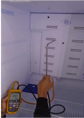
Figura 27. Medición de flujos de aire. Fuente: Autor
