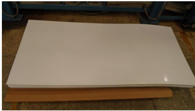
Figura 10. Lámina De Poliestireno de Alto Impacto PAI 1400x580x2mm. Fuente: Autor
