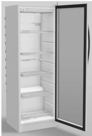
Figura 17. Enfriador vertical dibujado en Inventor. Fuente: Autor
