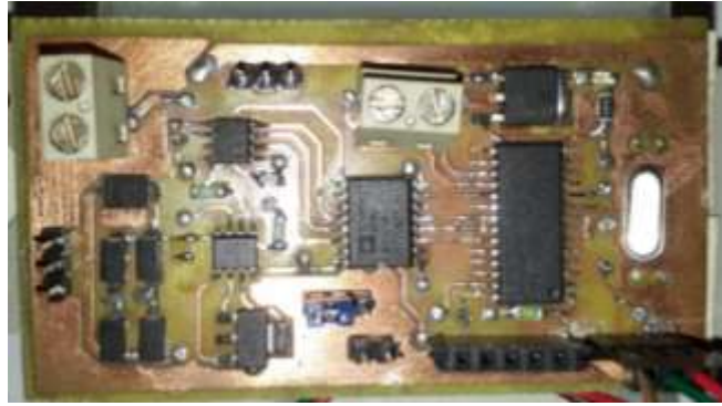
Figura 30.- Tarjeta transmisora de la celda de carga.
