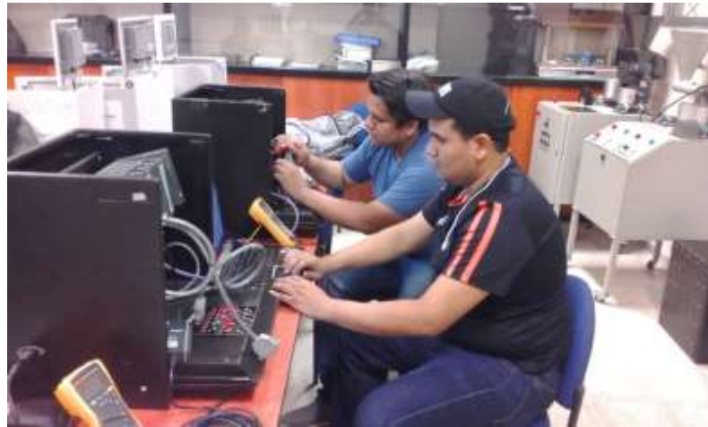
Figura 58.- Pruebas de funcionamiento de los diferentes módulos del PLC.
