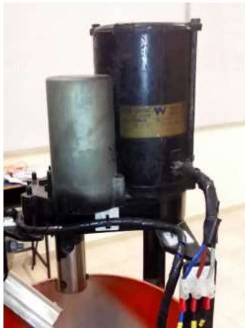
Figura 46.- Motor de engranaje Von Weise con una adaptación de paletas.
