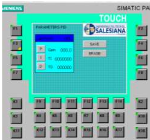
Figura 69.- Pantalla de ingreso de parámetros PID
