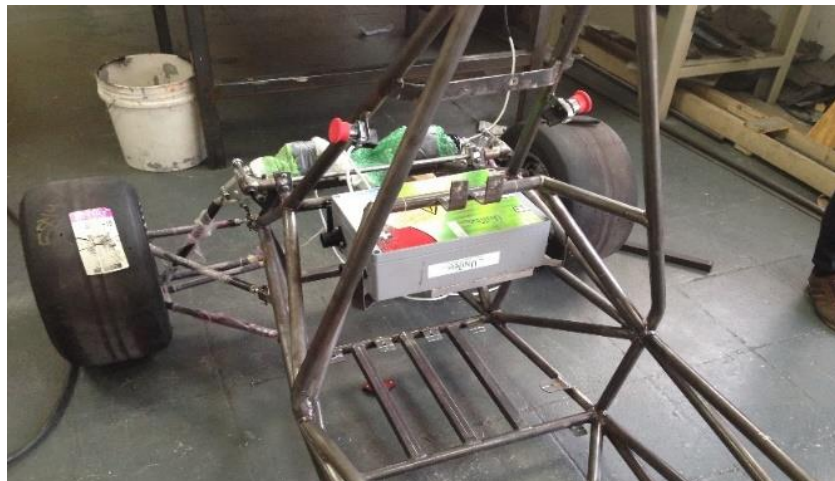
Figura 26 Instalacion del controlador Bamocar D3. [5]
