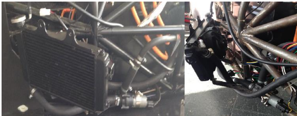
Figura 29 Montaje del sistema de refrigeracion. [5]
