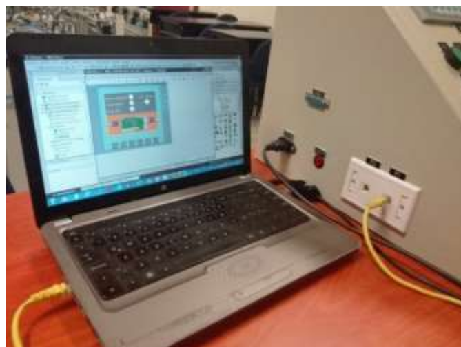
Figura 41. Conexión del cable RJ45 en el puerto P1.
