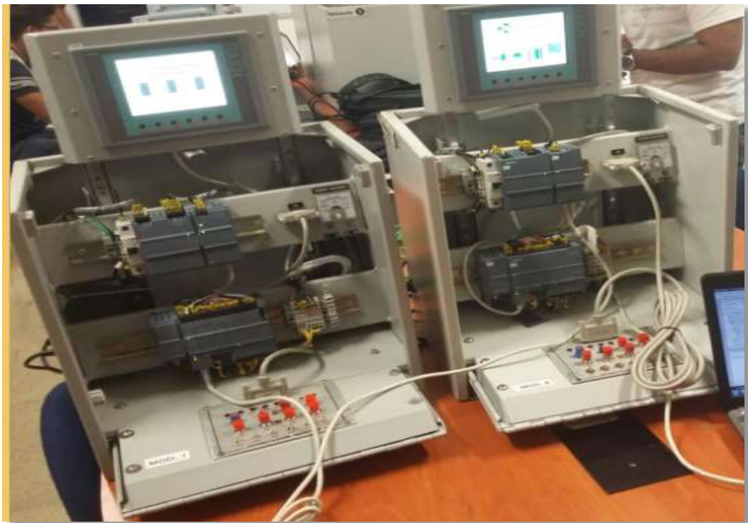
Figura 1. Módulos Siemens S7 1200.
