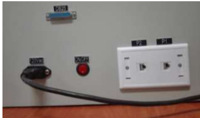
Figura 40. Conexión del cable de poder 120 Vac.
