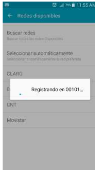
Figura 4.10. Dispositivo móvil Samsung S4 registrándose en la red OPENBTS.
