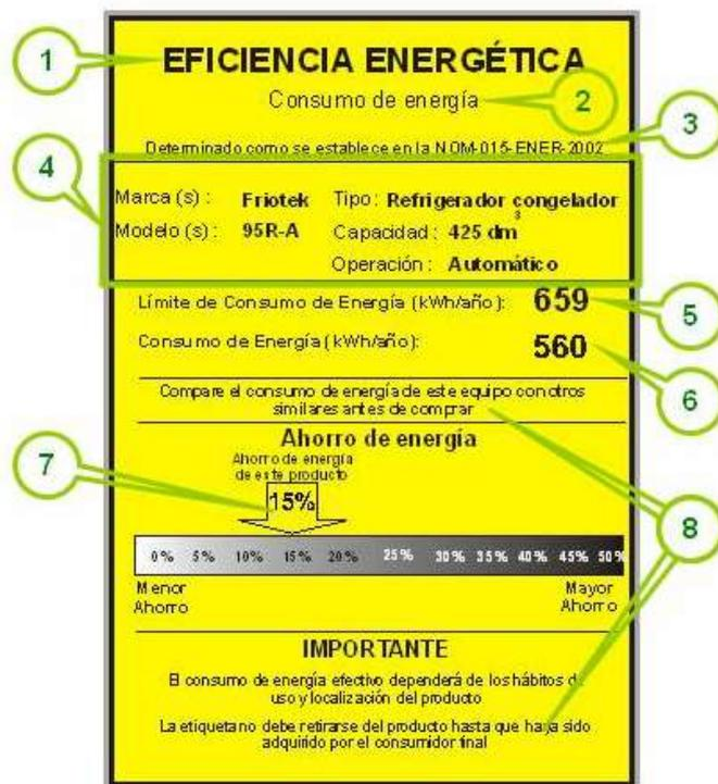
**Figura 26:** Partes de la etiqueta energética **Tomado de:** [46]
