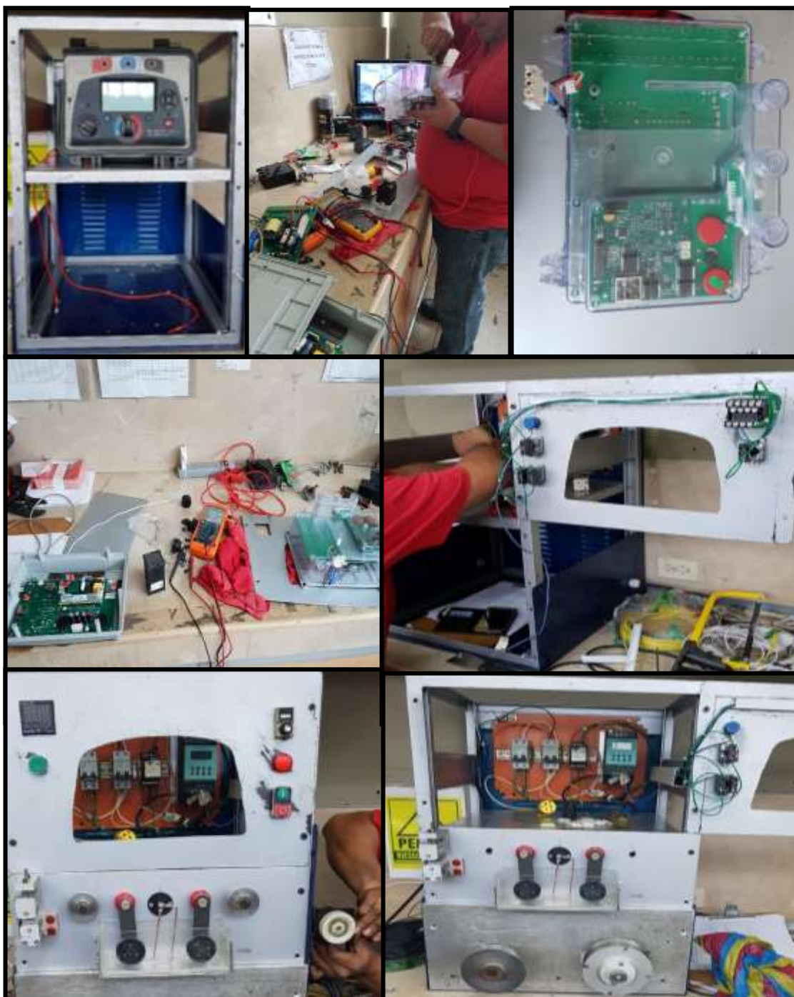
Figura 34: Ensamblaje de megger.
