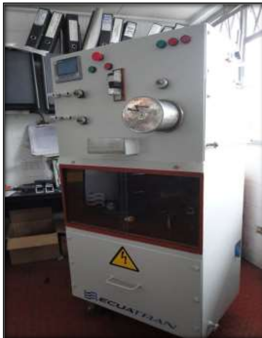
Figura 3: Equipo de pruebas para la verificación de continuidad del esmaltado.
