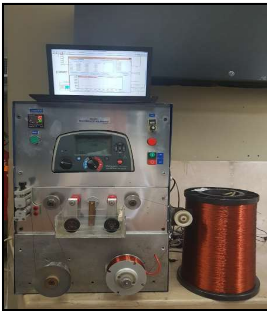
Figura 30: Equipo de Resistencia de Aislamiento.
