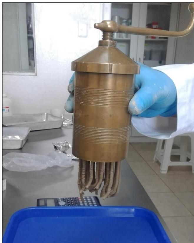
En esta imagen se muestra la forma en la que se obtiene el formulado en gránulos solubles, mediante el uso de un peletizador manual.
