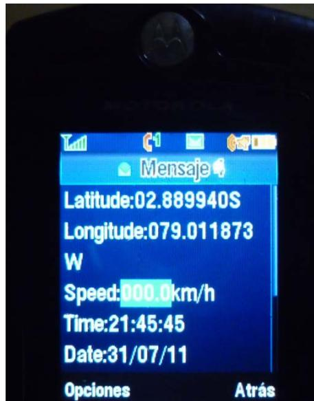
Figura 3.3 Pantalla Celular con Datos Geográficos de la Ubicación del Tracker
