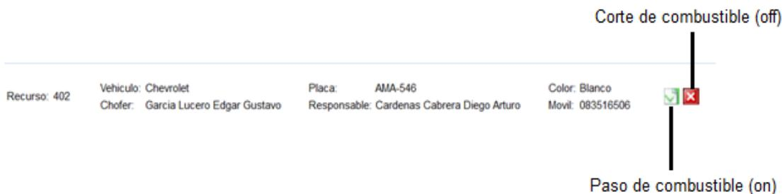
Figura 4.23: Paso y Corte de Combustible.
