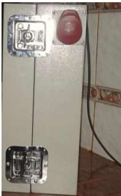
**Figura 40:** Toma trifásico implementado en los módulos.
