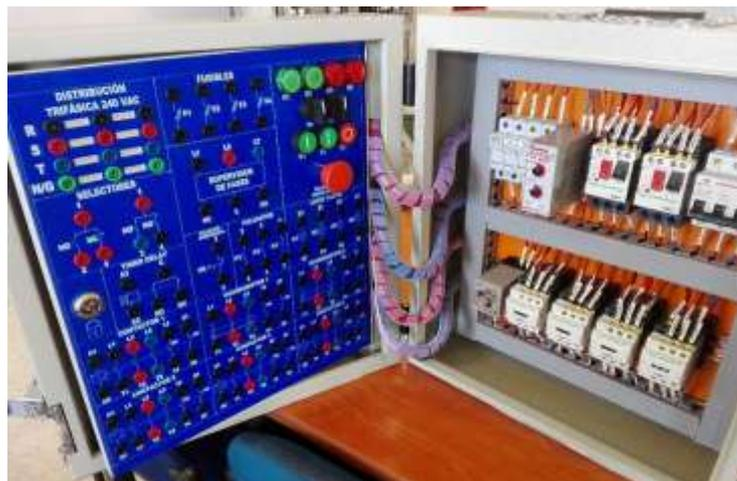
**Figura 38:** Montaje de los elementos de control y borneras en una de las caras internas del módulo.
