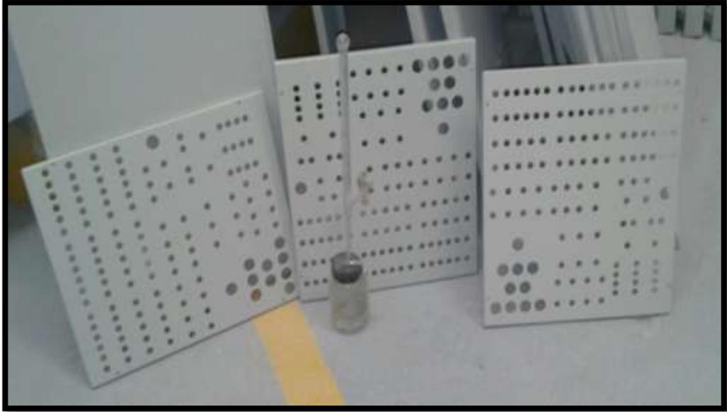
**Figura 78:** Placas de contrapuerta pintadas listas para ser montadas.
