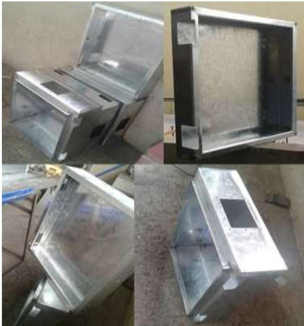
**Figura 32:** Módulos en su estado inicial, fabricados en Acero Inoxidable.
