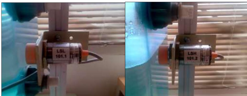
**Figura 38.** Sensores Capacitivos del tanque TK101.
