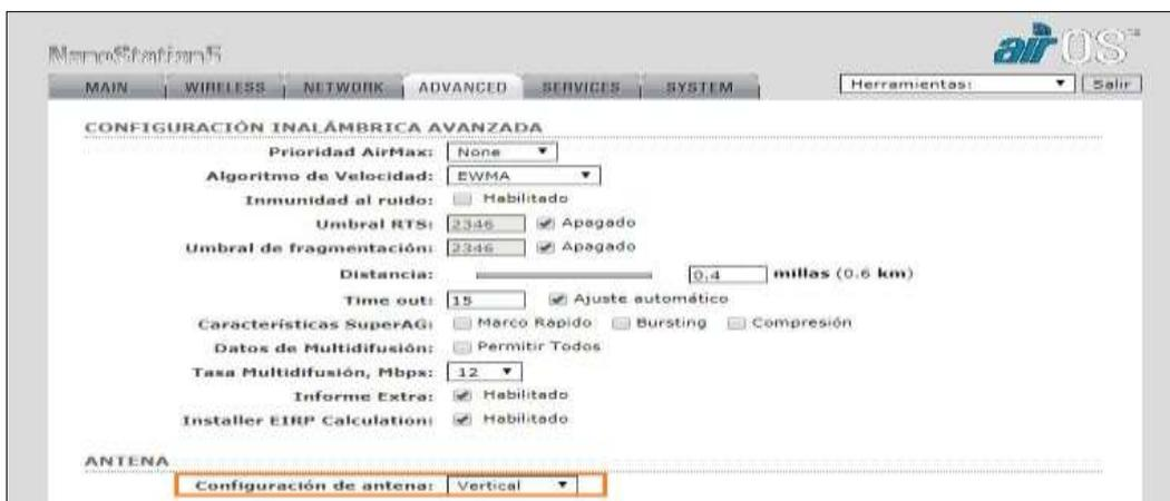
Figura 427. Puesta en servicio Antenas Ubiquiti Nanostation5
