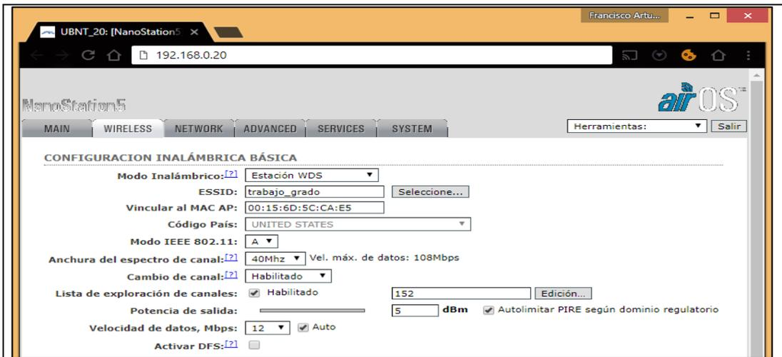
Figura 236. Configuración de la antena 002
