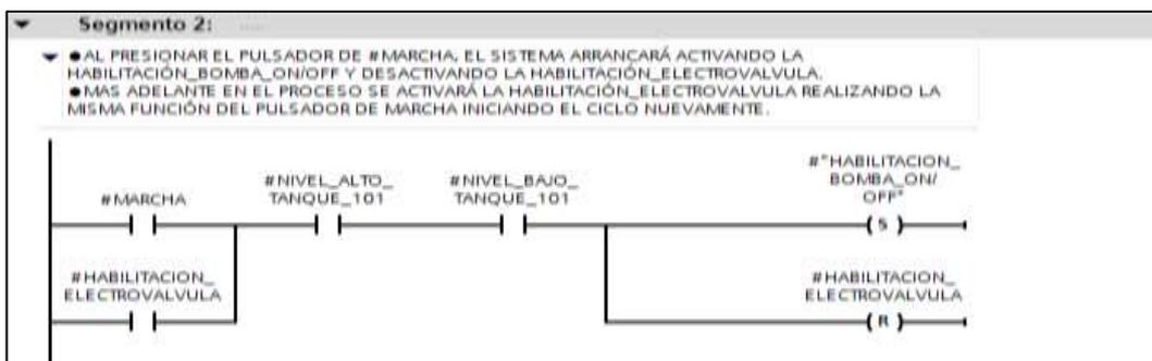
Figura 96. Segmento 2/Bloque FUNCION\_NIVEL[FC1]
