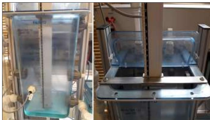
**Figura 45.** Montaje de la regla graduada en el tanque B102 de la Panta FESTO.
