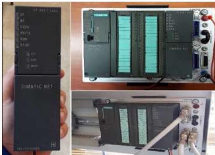
**Figura 42.** Montaje del módulo de comunicaciones CP343-1 LEAN en la Planta FESTO.
