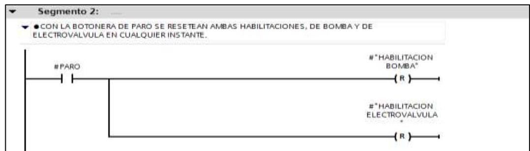
Figura 78. Segmento 2/Bloque AUTOMÁTICO[FC2]
