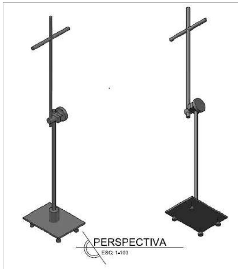
**Figura 60.** Diagrama del soporte móvil de la antena.
