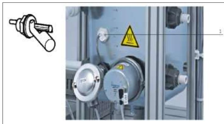
**Figura 6.** Sensor de protección de calefacción. (Festo Didactic, 2008)
