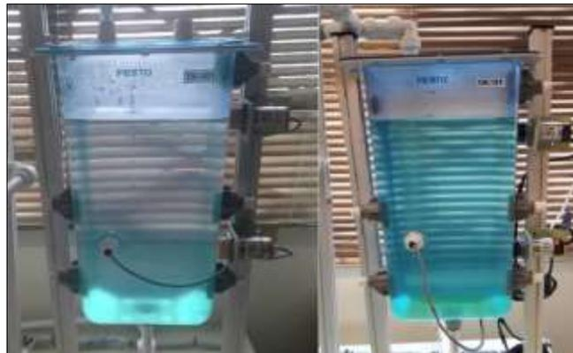
**Figura 46.** A la izquierda se encuentra el tanque TK101 con los sensores defectuosos, mientras que a la derecha está el mismo tanque con los nuevos sensores.
