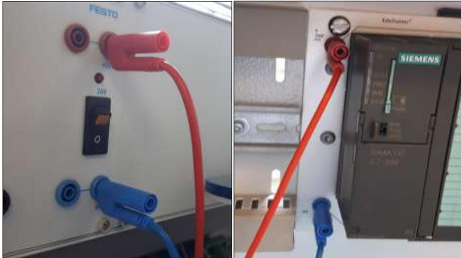
**Figura 411.** Conexión del PLC a 24 VDC.
