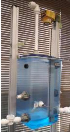
**Figura 39.** Sensor ultrasónico instalado en el tanque TK102.
