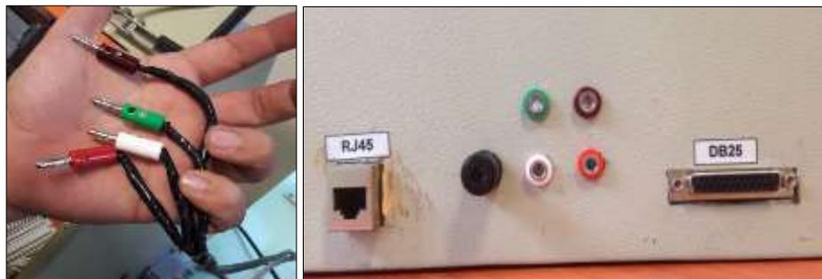
**Figura 47.** Detalle de los colores de los jack's del sensor ultrasónico.
