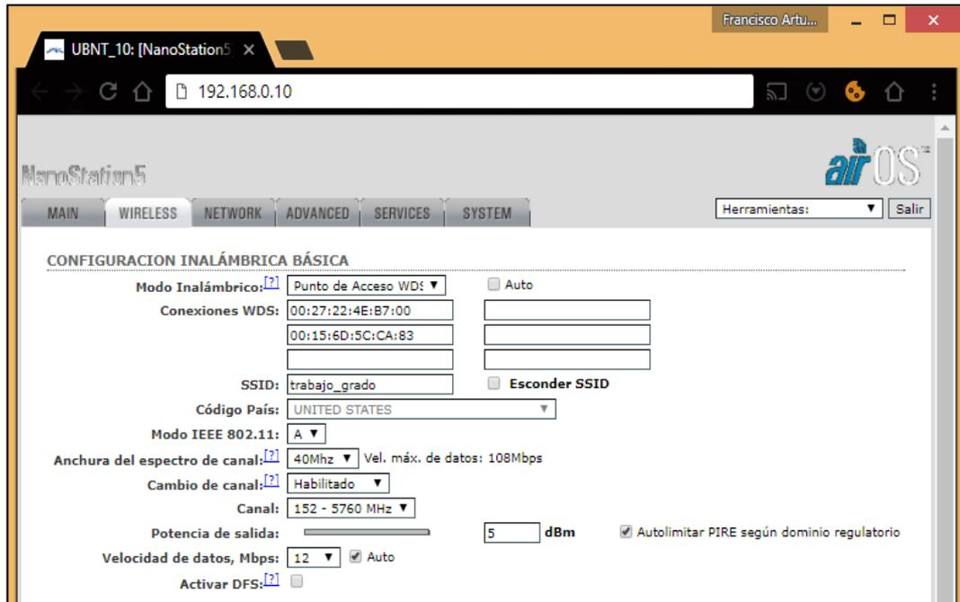
**Figura 322.** Configuración de la antena/Práctica 8
