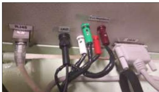
**Figura 48.** Conexión de los terminales del sensor ultrasónico al panel de control.
