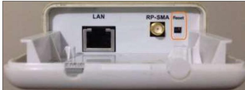
**Figura 414.** Ubicación del botón reset en la antena.
