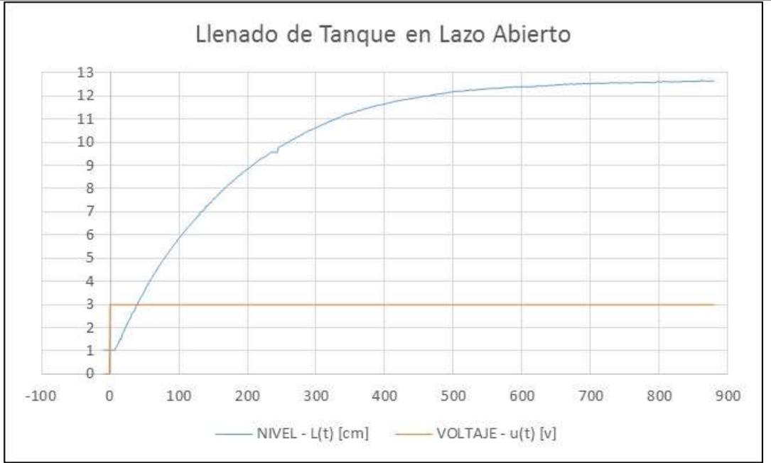
**Figura 392.** Curva de Función Escalón a lazo abierto
