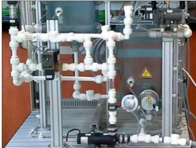
**Figura 409.** Tuberías y conectores de la Planta FESTO.
