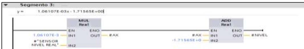
**Figura 381.** Programación Bloque Función [FC2] Segmento 3/ Practica010
