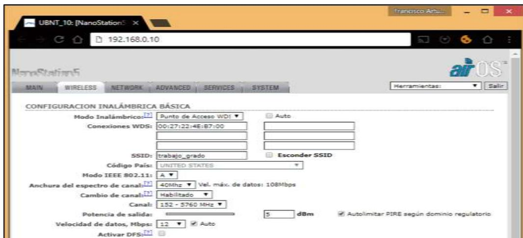
**Figura 265.** Configuración de la antena 001
