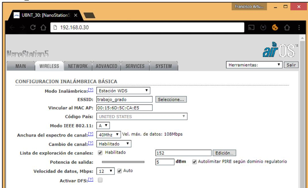
**Figura 360.** Configuración de antena Ubiquiti conectada al computador de control y monitoreo
