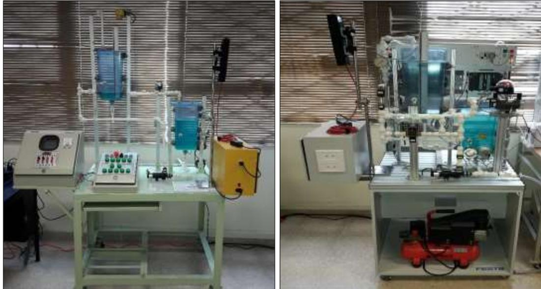
**Figura 398.** Planta de Control de Nivel (izquierda) y Planta FESTO (derecha) con sus respectivos módulos de comunicación y soportes de antenas.
