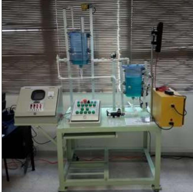
**Figura 63.** Soporte y panel instalado en la Planta de Control de Nivel.
