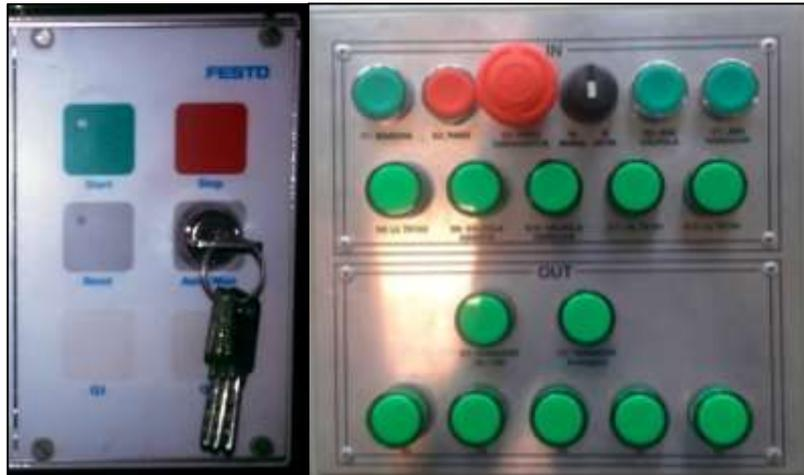
**Figura 149.** Panel de mando de la Planta Compact Workstation de FESTO (izquierda) y Panel de mando de la Planta Didáctica para Control de Nivel (derecha)
