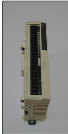
Figura 7. Módulo de Entradas y salidas análogas
