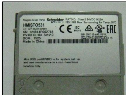
Figura 10. Datos de placa HMI STO531
