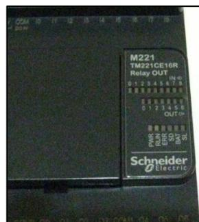
Figura 6. Visualización de entradas y salidas PLC Modicon 221
