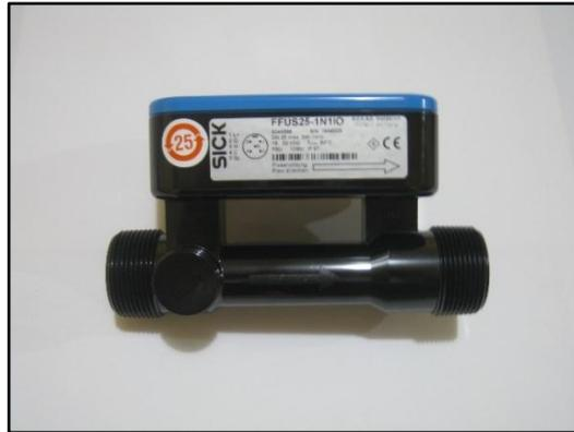
Figura 3. Dato de placa Sensor de flujo
