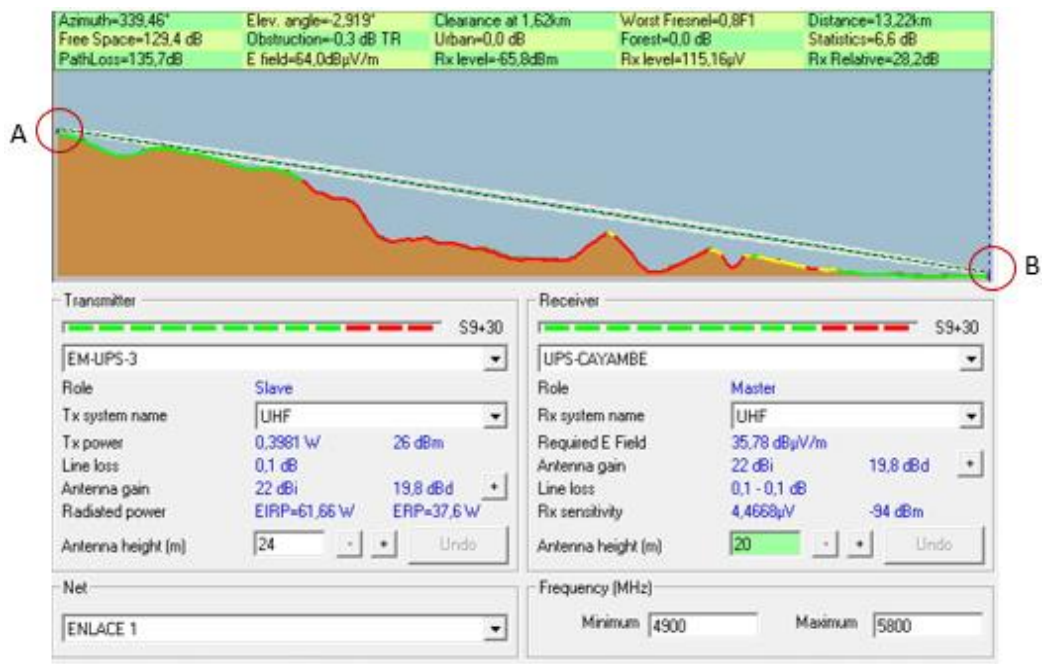
Figura 3. 3 Simulación del enlace UPS Cayambe a EM-UPS-3 (Radio Link) Realizado Por: Tania Aguirre y Rodrigo Suárez
