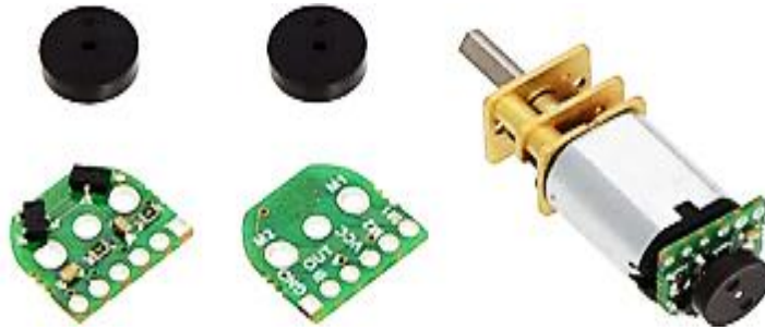
Encoder magnético Pololu, Fuente: (Pololu Robotics and Electronics, 2016)
