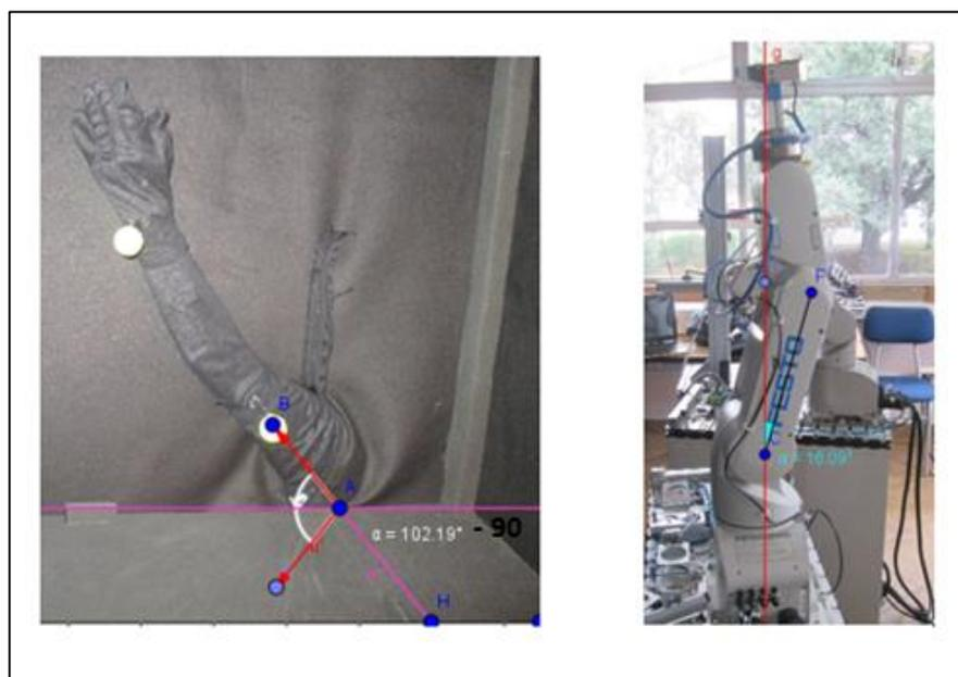
a) Medición del ángulo de elevación J2
