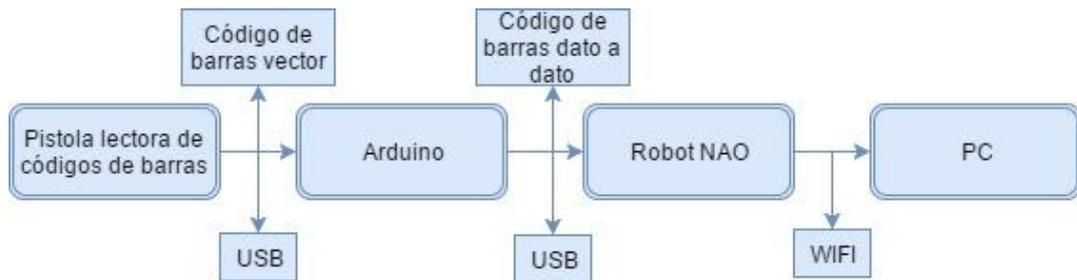
Diagrama de la interfaz de conexión entre la pistola lectora de código de barras y el robot NAO.
