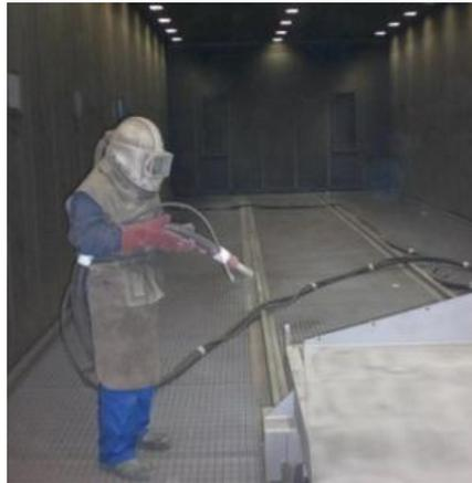
**Fuente:** DAGA, cabina chorreadora arena – Máquina granallado, 2010
