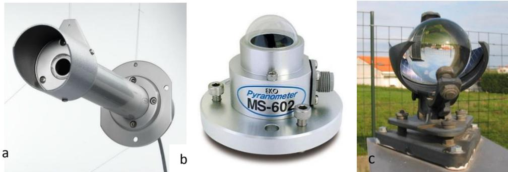
Ilustración 2: Equipos de medición de radiación solar. a) Pirheliómetro, b) Piranómetro, c) Heliofanógrafo. Fuente: (AEMET, 2010).
