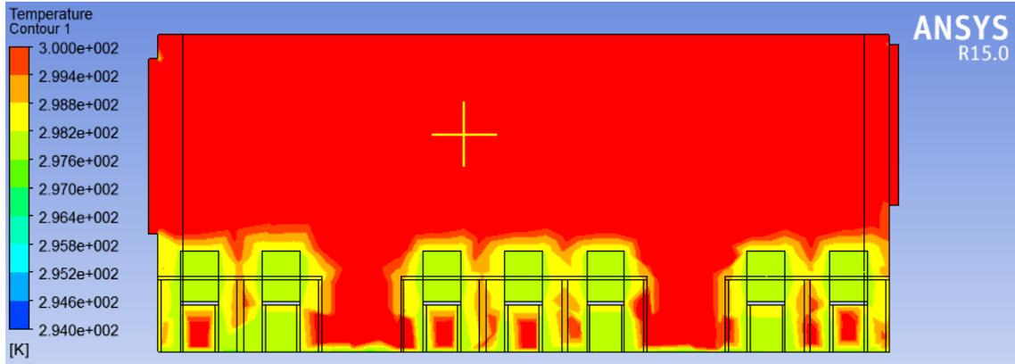
Figura 63. Simulación del Aula con el Sistema de Aire Acondicionado en un tiempo de 0 s. FUENTE. AUTOR
