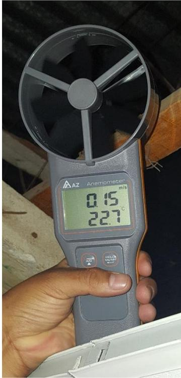
Imagen 4. Velocidad de viento entre el techo y el gypsum. Fuente. Autor
