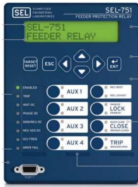
FIGURA 21: RELÉ DE PROTECCIÓN SEL 751 (PARTE FRONTAL)
