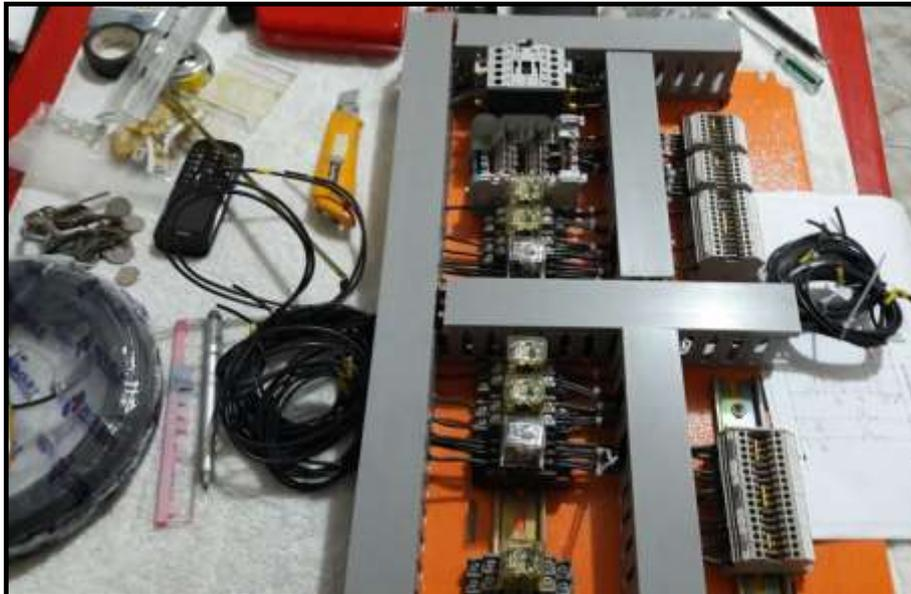
FIGURA 183: CABLEADO DE SEÑALES
