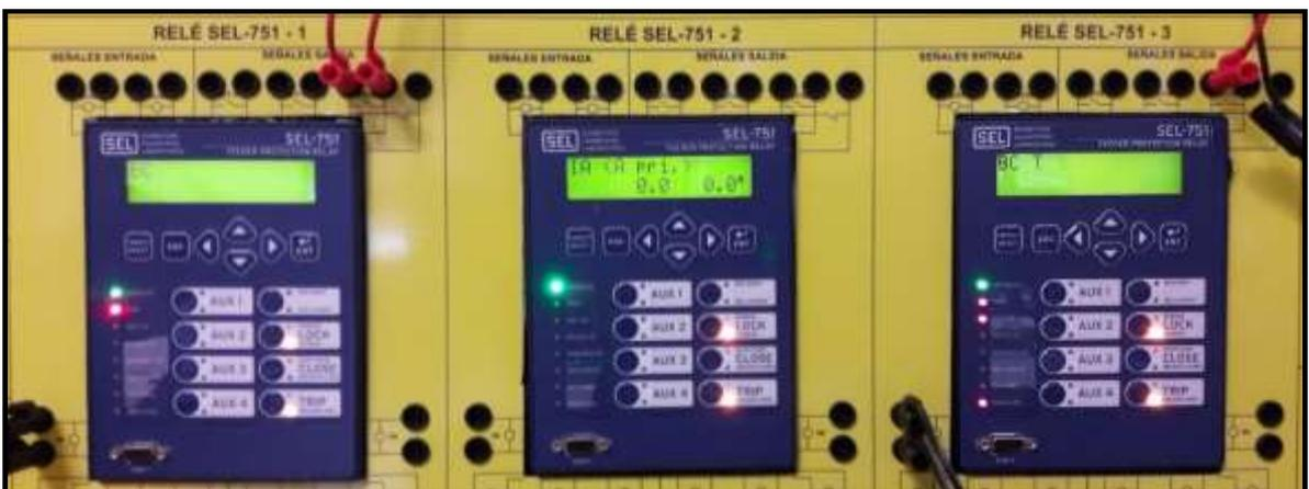
FIGURA 191: FALLA EN ALIMENTADOR DE SALIDA 2 – 50P Y BREAKER FAIL TRIP IED3 – BFT - APLICANDO METODOLOGÍA GOOSE
