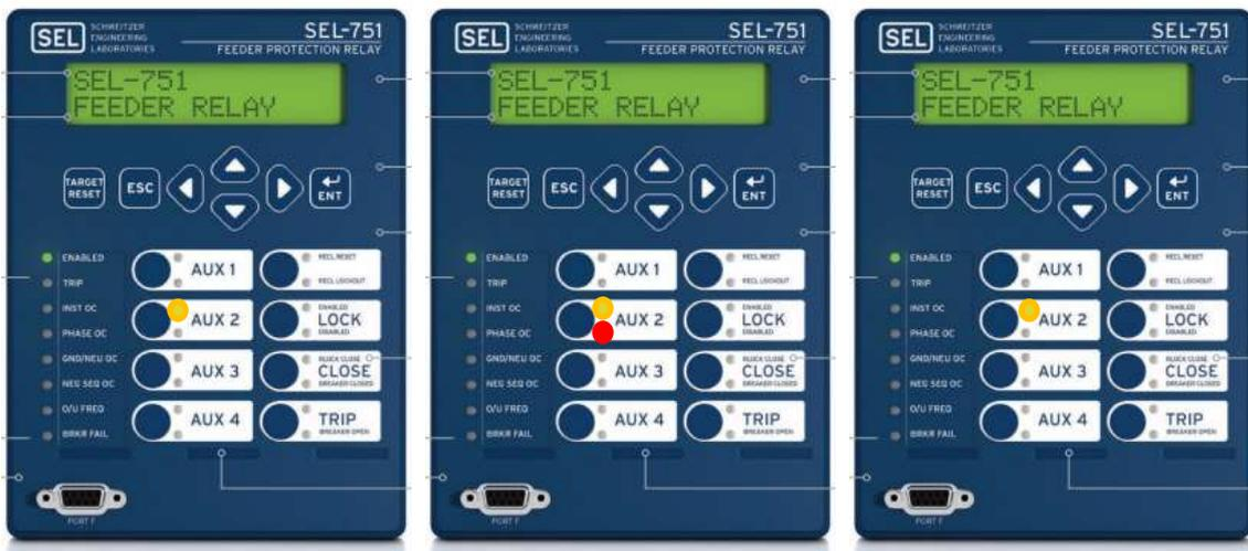
FIGURA 172: PRUEBA3 – SOBRECORRIENTE TEMPORIZADA – 51P1P IED2
