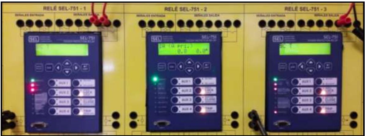
FIGURA 190: FALLA EN ALIMENTADOR DE SALIDA 2 – 50P Y BREAKER FAIL TRIP IED3 – BFT - APLICANDO METODOLOGÍA CONVENCIONAL
