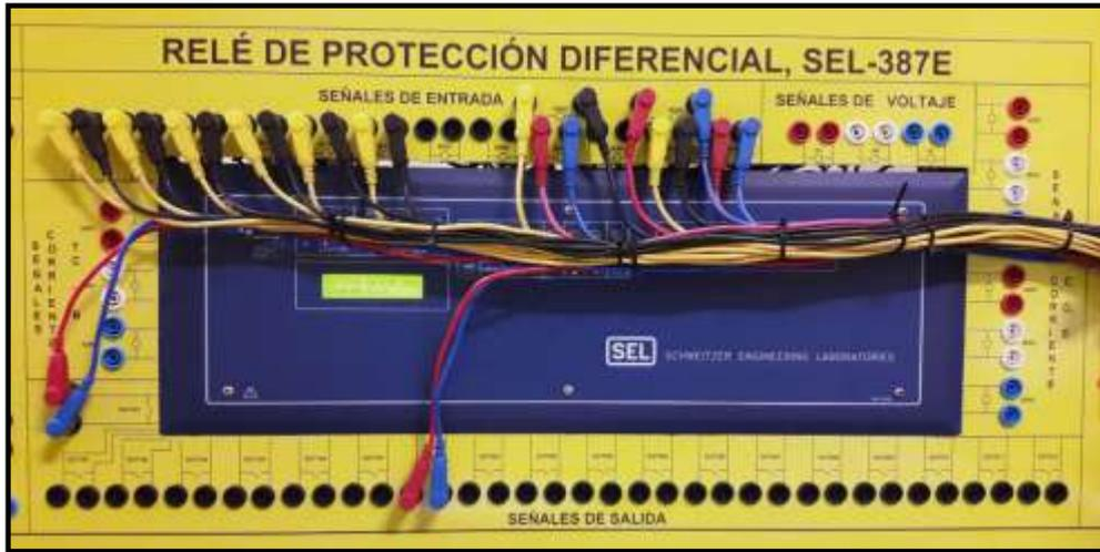
FIGURA 146: PRUEBA2 – IED4 – CONCENTRADOR DE SEÑALES
