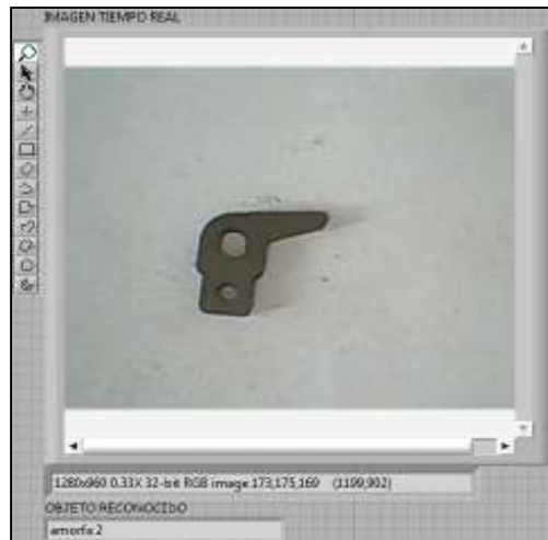
Fig 81. Reconocimiento de una pieza metálica
