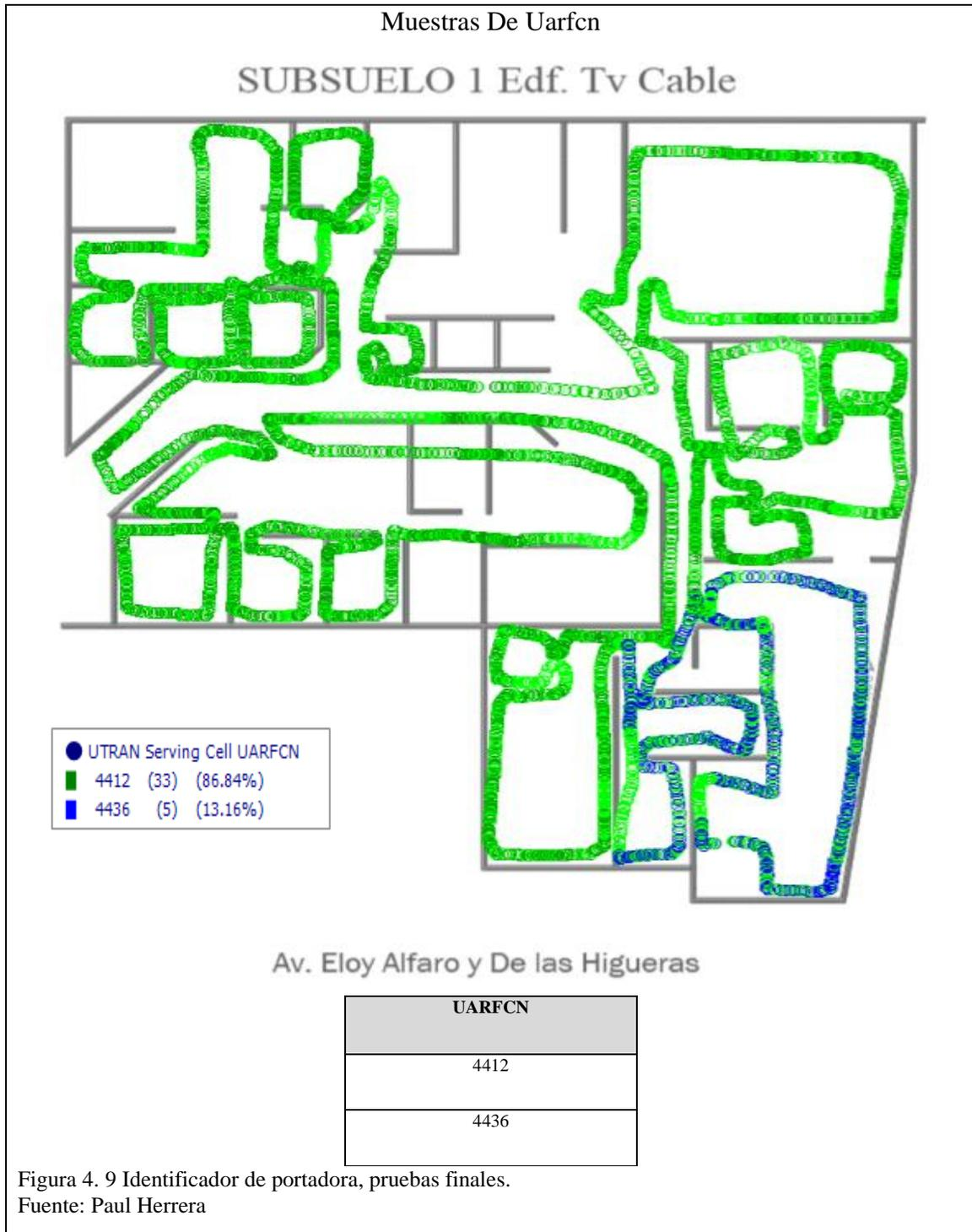
Figura 4. 9 Identificador de portadora, pruebas finales.
