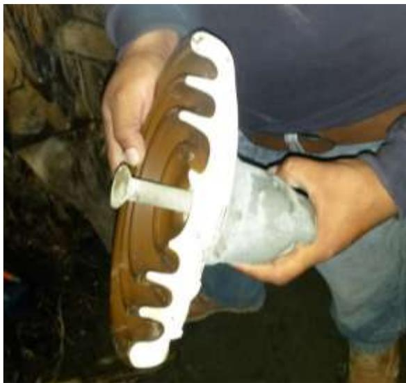
ANEXO 12 FIGURA MODO DE FALLA DESCARGA ATMOSFÉRICA AISLADOR FOGONEADO
