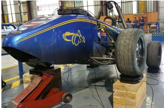
**Figura 34 Gato hidráulico aplicado para las pruebas en el FSAE**
