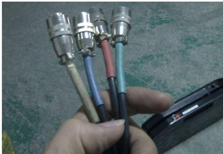
**Figura 31 Identificación de los cables mediante colores Equipo Proform Scale**
