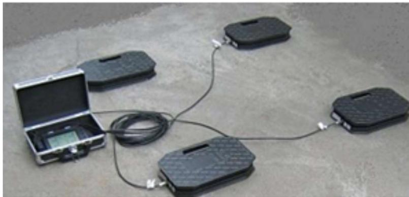
**Figura 28 Equipo de pesaje Proform Scale.**
