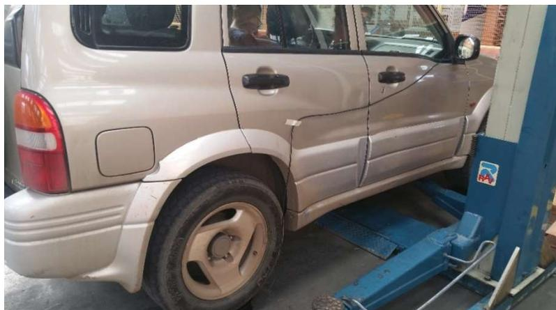
**Figura 33 Colocación de balanzas con elevador hidráulico de 2 postes.**
