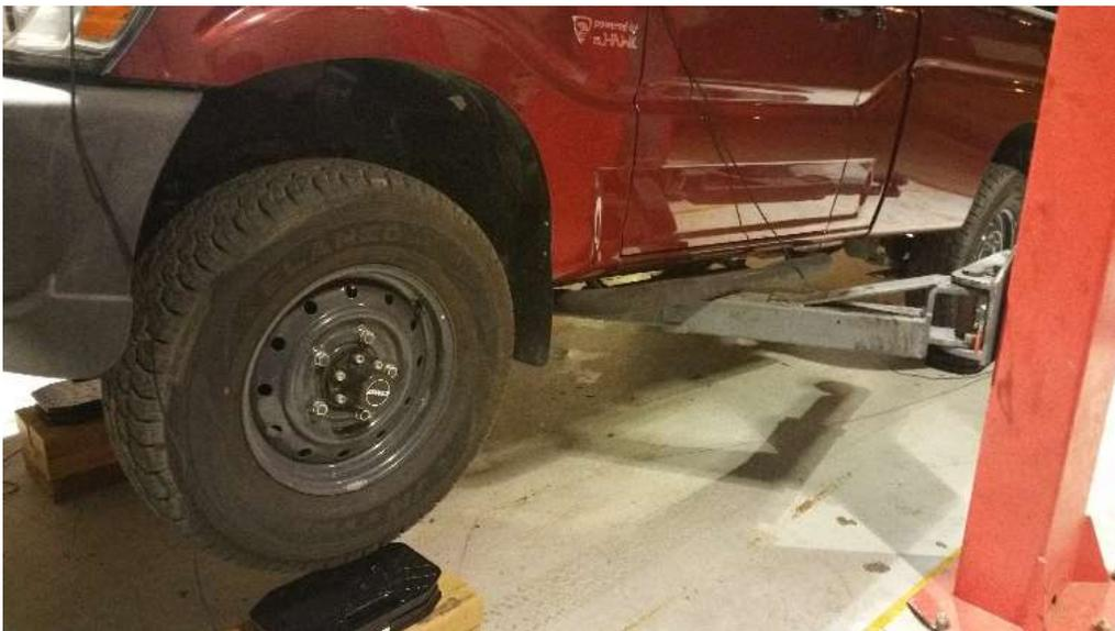
**Figura 18 Variación de altura para la generación de transferencia de pesos.**
