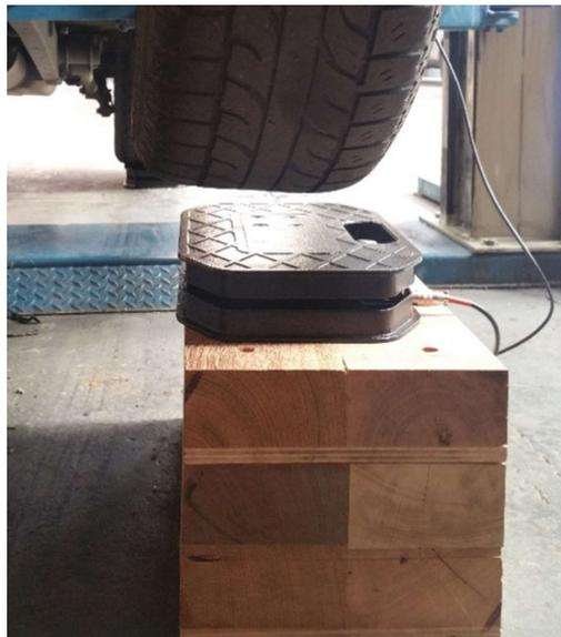
**Figura 35 Colocación de la balanza sobre alzas en una superficie nivelada.**
