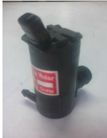
Figura 3.22. Bomba de agua para humedecer la trampa.
