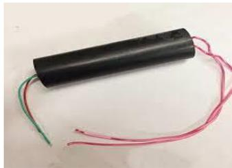
Figura 3.21. Generador del Arco Eléctrico
