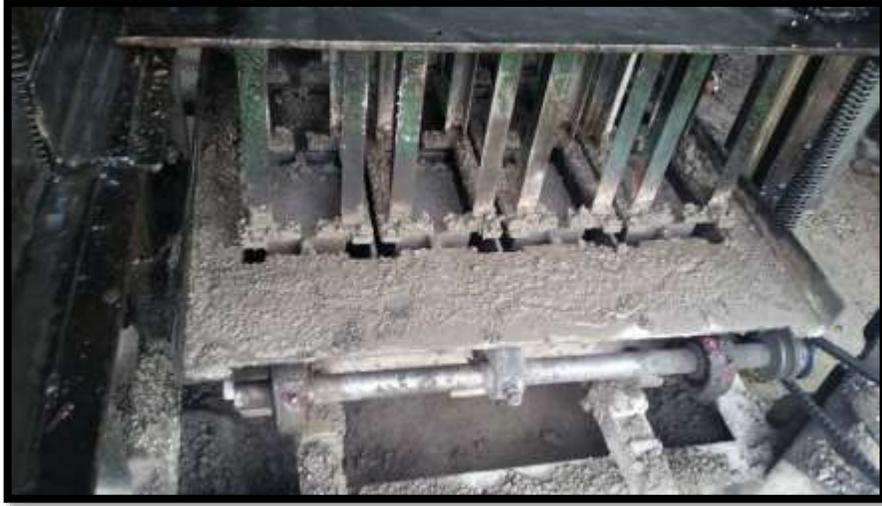
Figura 2.3. Moldes para la fabricación de bloques de cemento. Fuente: (Autores)
