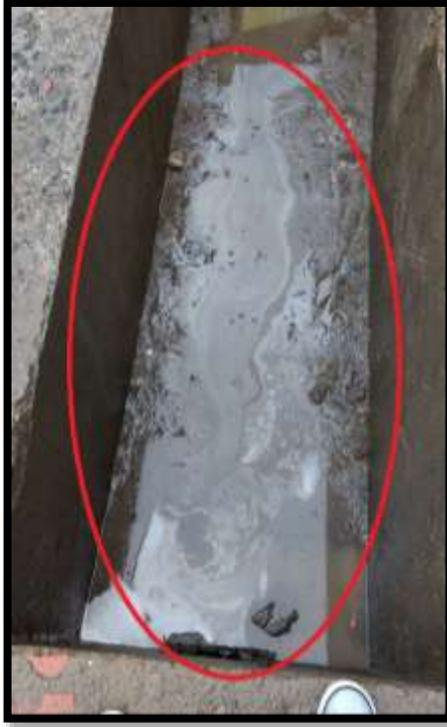
*Figura 2.2. Contaminación del agua con aceite usado provocada por la pulverización. Fuente: (Autores).*
