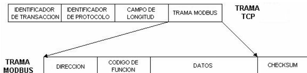
*Figura 20. Esquema encapsulado de Modbus TCP (Andrés Ruiz, 2002)*
