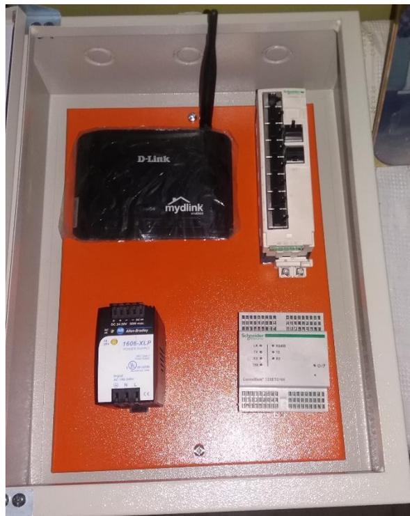
**Figura 28. Montaje de equipos del módulo convertidor Modbus TCP (Autores, 2017)**
