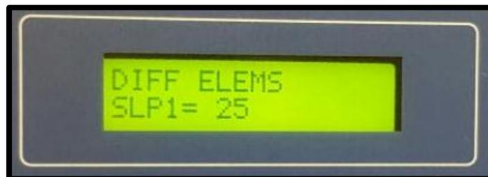
FIGURA 146: PENDIENTE INICIAL DE OPERACIÓN PARA PROTECCIÓN DIFERENCIAL DE BARRA, SE INICIA EN EL ORIGEN. FUENTE: LOS AUTORES.
