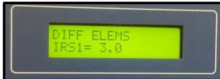
FIGURA 145: CORRIENTE DE RESTRICCIÓN O INTERSECCIÓN DE PENDIENTE 1 CON PENDIENTE 2 PARA PROTECCIÓN DIFERENCIAL DE BARRA. FUENTE: LOS AUTORES.
