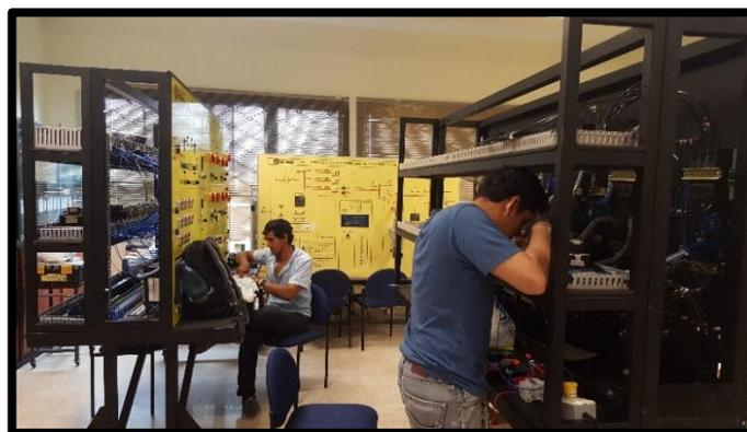
FIGURA 43: MÓDULO DE DISTRIBUCIÓN. CABLEADO DE CIRCUITO DE FUERZA CON CABLE CU #8 THHN. FUENTE:
