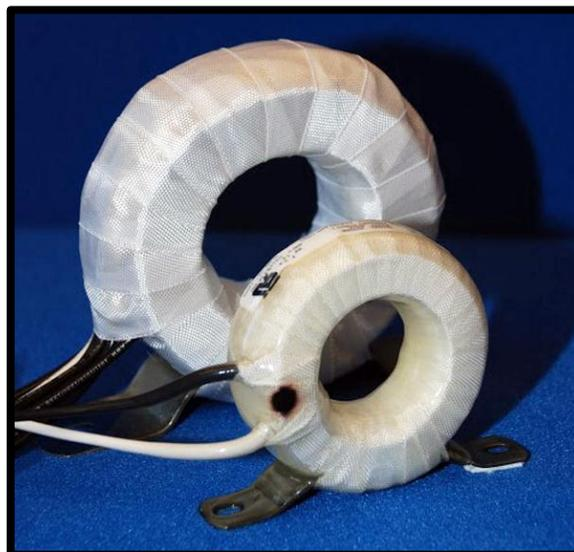
FIGURA 79: TRANSFORMADOR DE CORRIENTE. FUENTE: LOS AUTORES.
