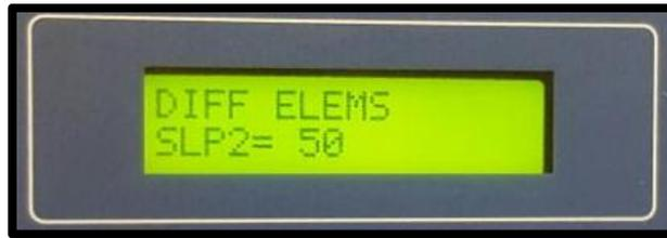
FIGURA 147: SEGUNDA PENDIENTE DE OPERACIÓN PARA PROTECCIÓN DIFERENCIAL DE BARRA, DEBE SER MAYOR QUE LA PENDIENTE 1. FUENTE: LOS AUTORES.
