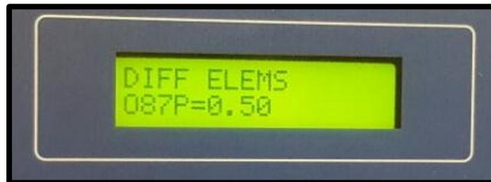
FIGURA 144: MÍNIMO NIVEL DE IOP REQUERIDO PARA LA OPERACIÓN EN AJUSTES PARA PROTECCIÓN DIFERENCIAL DE BARRA. FUENTE: LOS AUTORES.
