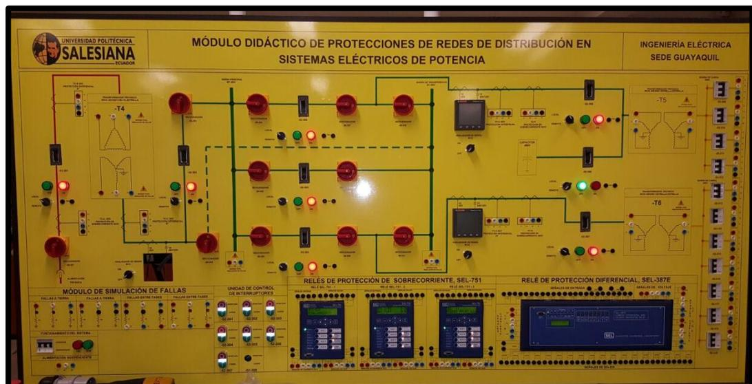
FIGURA 50: MÓDULO DE DISTRIBUCIÓN. TABLERO ENERGIZADO CON CIRCUITO DE CONTROL EN OPERACIÓN. FUENTE: LOS AUTORES.
