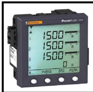
FIGURA 89: MEDIDOR DE PARÁMETROS MERLIN GERIN PM700. FUENTE: [32].
