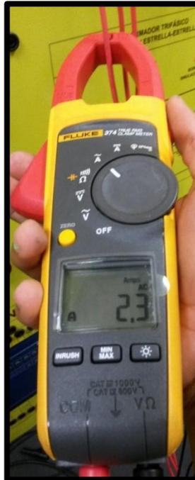
FIGURA 57: MÓDULO DE DISTRIBUCIÓN. MEDICIÓN DE CORRIENTE EN LA FASE C DEL ALIMENTADOR DE -T5 POR MEDIO DE AMPERÍMETRO. FUENTE: LOS AUTORES.
