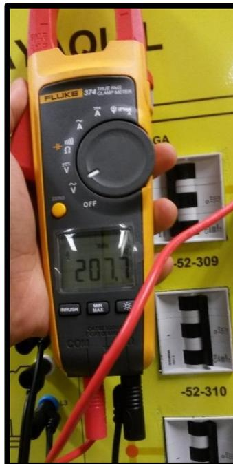
FIGURA 58: MÓDULO DE DISTRIBUCIÓN. MEDICIÓN DE VOLTAJE EN LA BARRA DE CARGA POR MEDIO DE VOLTÍMETRO. FUENTE: LOS AUTORES.
