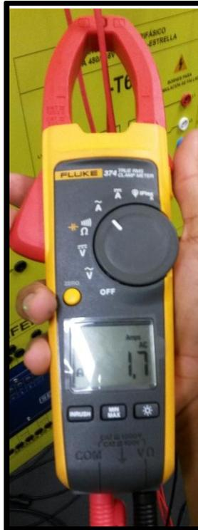
FIGURA 55: MÓDULO DE DISTRIBUCIÓN. MEDICIÓN DE CORRIENTE EN LA FASE B DEL ALIMENTADOR DE -T5 POR MEDIO DE AMPERÍMETRO. FUENTE: LOS AUTORES.
