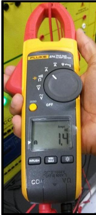
FIGURA 53: MÓDULO DE DISTRIBUCIÓN. MEDICIÓN DE CORRIENTE EN LA FASE A DEL ALIMENTADOR DE -T5 POR MEDIO DE AMPERÍMETRO. FUENTE: LOS AUTORES.
