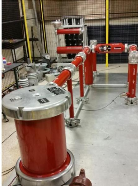
**ILUSTRACIÓN 17: Circuito generador de impulso**
