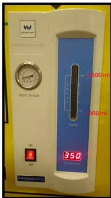
Figura 16: Generador de Hidrógeno
