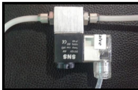
Figura 28: Electroválvula para Control de Sobre Presiones de Gas Hidrógeno
