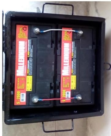
**Figura 30:** Baterías Millennium conectadas en paralelo
