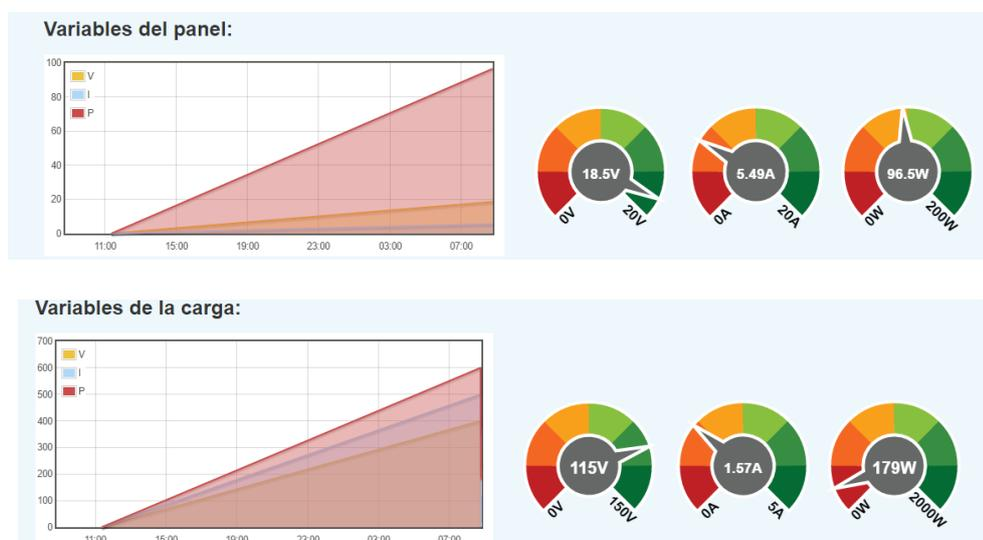
**Figura 66:** Dashboard del proyecto con los datos medidos en tiempo real
