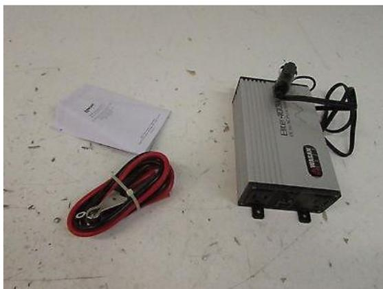
**Figura 31:** Inversor de voltaje, con entrada de 12 Vdc y salida de 120 Vac
