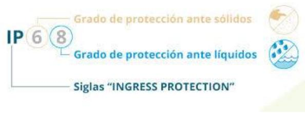
**Figura 10:** Ejemplo de un grado de protección IP
