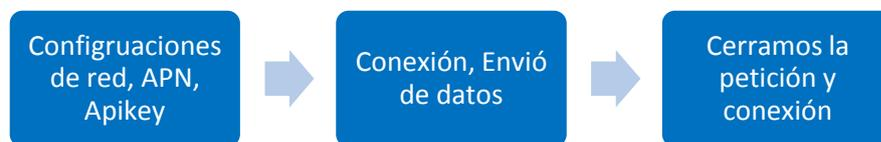
**Figura 65:** Diagrama de bloques de la conexión GPRS
