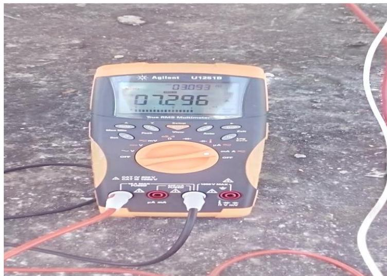
**Figura 61:** Medición de corriente del módulo fotovoltaico en corto circuito
