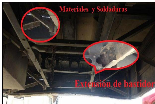
*Figura 2. 17.* Extensión, Materiales y Soldaduras
