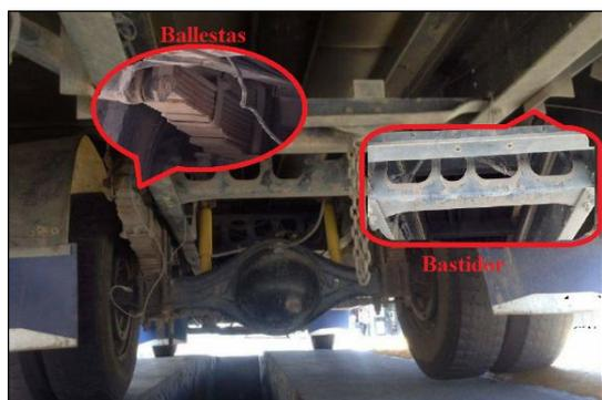
*Figura 2. 7.* Bastidor y ballestas
