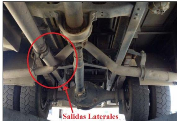
*Figura 2. 18.* Salidas laterales del tubo de escape
