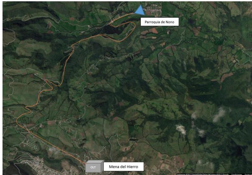
Figura 33. Distancia de la fibra óptica desde el OLT hasta el primer nivel de splitting
