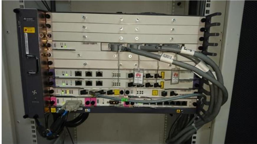
Figura 9. MA5603T implementado en laboratorio.
