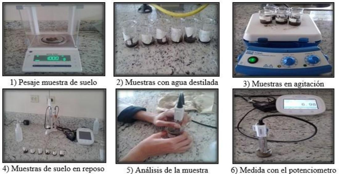
**Figura 6.** Procedimiento para determinar pH.
