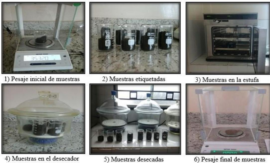
**Figura 5.** Procedimiento para determinar humedad del suelo.
